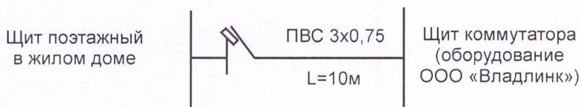
Граница балансовой принадлежности между **«УК»** и **«Потребителем»** устанавливается (**отмечено красной чертой**) на каб. зажимах в Щите Этажном 0,4кВ.
