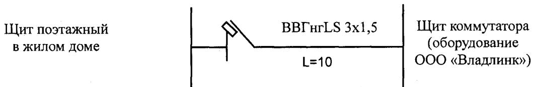
Граница балансовой принадлежности между «УК» и «Потребителем» устанавливается (отмечено красной чертой) на каб. зажимах в Щите Этажном 0,4кВ.
